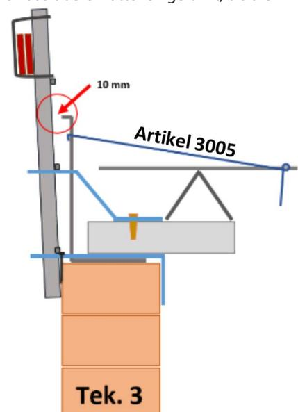
Verwenden Sie die GSS-Schnellbefestigung 3005 und achten Sie darauf, dass die Randschalung den Pfosten nicht berührt! Wenn das GSS-Profil durch den eingegossenen Beton gegen den Pfosten gedrückt wird, ist die Demontage danach sehr schwierig! (Siehe roter Kreis Abb. 3)
